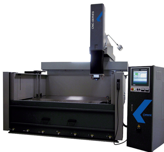
Obrázek 1 Stroj Penta 2010 CNC z portfolia hloubiček, při jejichž vývoji se společnost Penta Trading zaměřuje na udržení výborného poměru ceny a výkonu.
